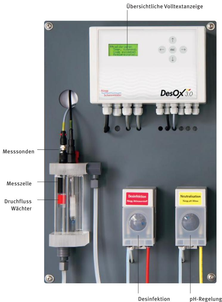
**Mess- und Regelgerät DesOx 3.0** für pH- und Desinfektion, inkl. Temperaturanzeige. Im Wand-aufbau-Gehäuse IP 54, mit LCD-Display 60 x 25 mm, 4-zeilig, hintergrundbeleuchtet. Intuitives, einfaches Bedienen über die Folientastatur und Volltextanzeige im Display.
